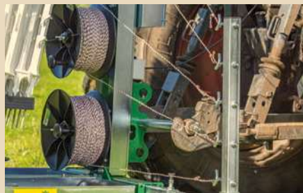
Bis zu 5 Litzen können gleichzeitig gezogen oder aufgerollt werden
