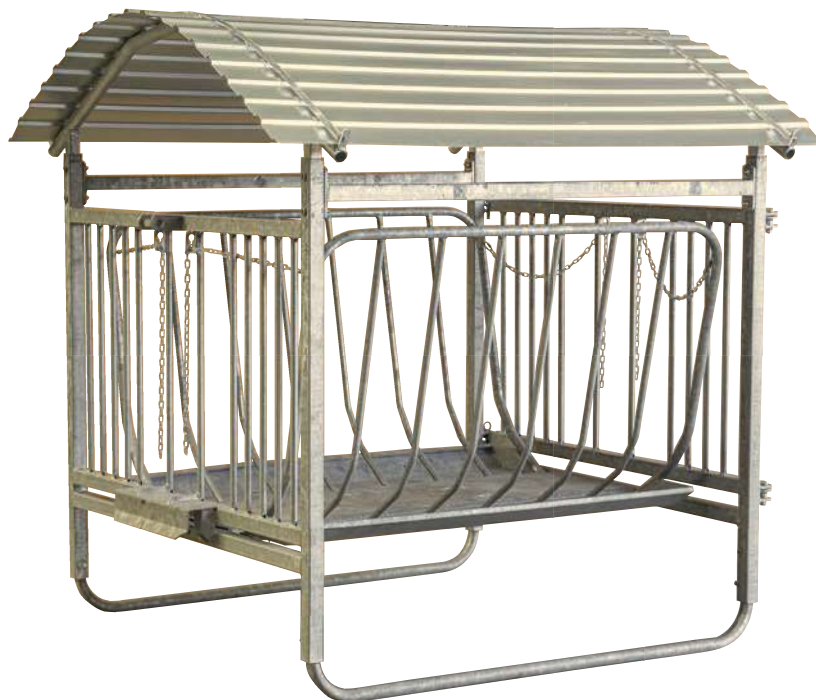
Eine lichte Fressgitterbreite von 19 cm für Schafe bzw. 9 cm für Ziegen ermöglicht ein sicheres Einfädeln der Tiere ohne das Risiko des Verfangens
