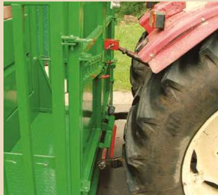
5 Transport über Ackerschiene und Oberlenker
