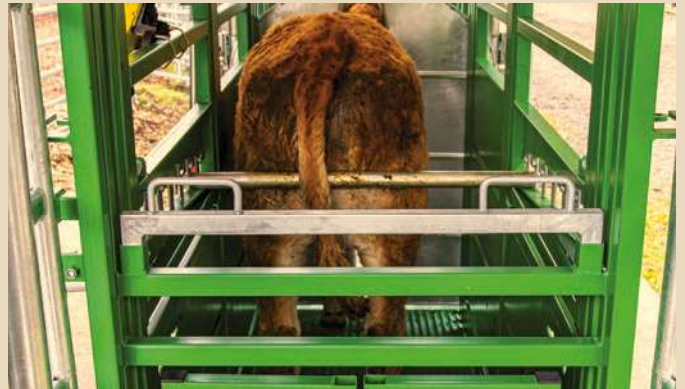
5 Fixieren des Tieres von hinten durch Beckenstange
