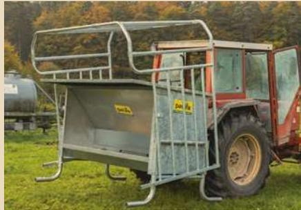
Transport über Dreipunkthängung mit hochgeklapptem Kälberschlupf
