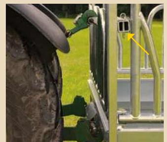
Einfacher Transport über Ackerschiene und abnehmbarer Oberlenkeranhänger aus 8 mm starkem Vierkantröhre
